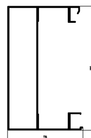
Płatew/krokiew skrajna o wymiarach 120×190 mm
